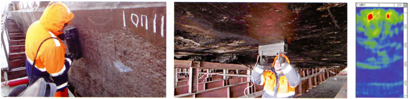
Рис.3. Поиск скрытых дефектов в бетоне конструкций. Результат сканирования
