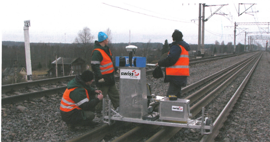
Рис. 2. Внешний вид путеизмерительного комплекса Swiss Trolley
